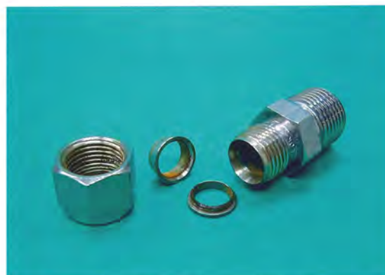
熱処理したリアフェラルによるさびの発生例
